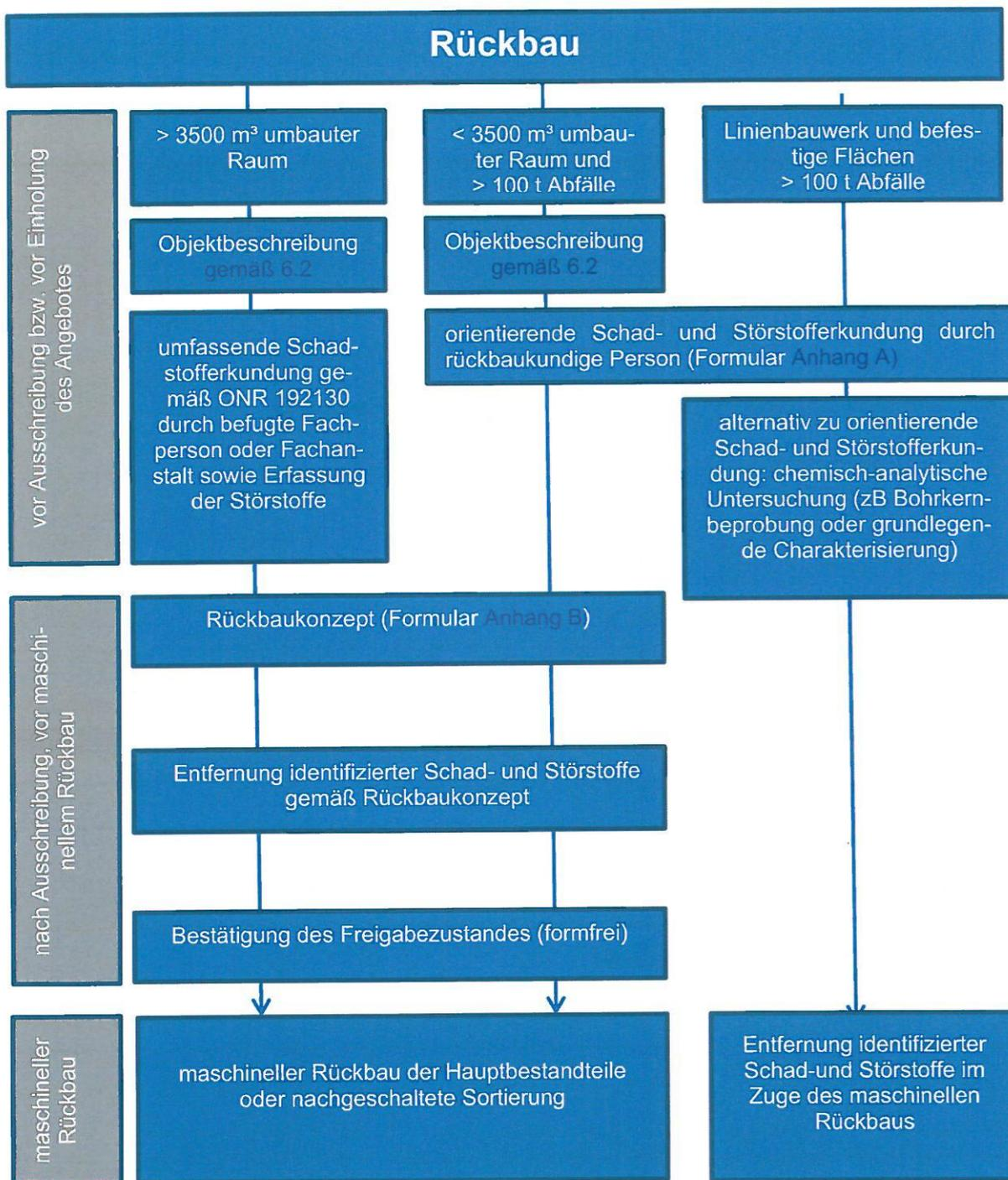
Bild C.1 — Rückbau
